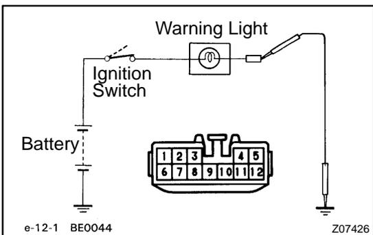
**22. INSPECT LIGHT FAILURE WARNING LIGHT**
