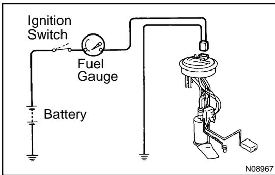
**5. INSPECT FUEL RECEIVER GAUGE OPERATION**
