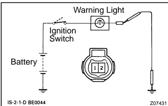
**16. INSPECT ENGINE OIL LEVEL WARNING LIGHT**
