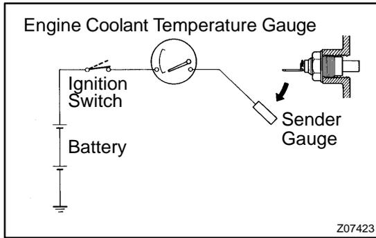
**10. INSPECT ENGINE COOLANT TEMPERATURE RECEIVER GAUGE OPERATION**
