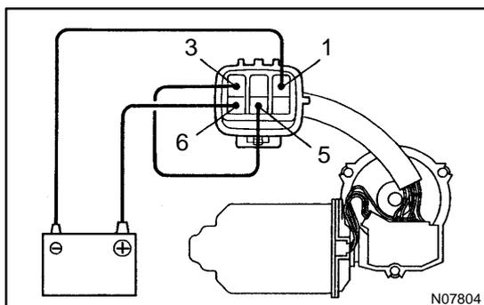
**8. INSPECT REAR WIPER MOTOR AND RELAY OPERATION**
