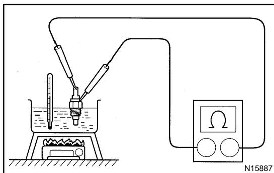
**12. INSPECT ENGINE COOLANT TEMPERATURE SENDER GAUGE RESISTANCE**
