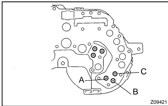
**11. INSPECT ENGINE COOLANT TEMPERATURE RECEIVER GAUGE RESISTANCE**
